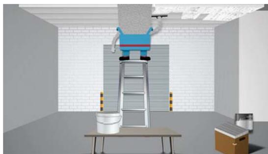
\* Il pannello di isolamento termico, sulla cui superficie e' stato spalmato il collante, si incolla tenendolo a distanza di 2 cm dagli altri pannelli di isolamento termico incollati al soffitto.
