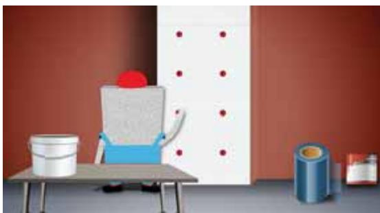
\*Если поверхность, которая будет утепляться, не оштукатурена, в этом случае, клеящий раствор наносится на поверхность теплоизоляционной плиты с помощью стального мастерка несколькими лепешками посередине утеплителя и по периметру плиты (отступив от края плиты 5 мм). Клеящим раствором должно быть покрыто 40% теплоизоляционной плиты.
