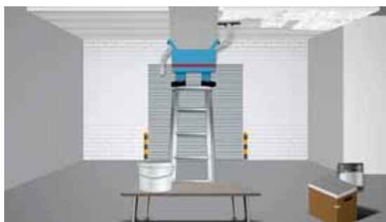
\*Теплоизоляционная плита, на поверхность которой нанесен клеевой раствор, прикладывается к потолку, сместив от других плит на 2 см. Придерживая ладонями и выравнивая плиту по плоскости, плита вплотную прижимается к соседним плитам и удерживается ладонями в течение 5 секунд. При необходимости, изоляционная поверхность выравнивается с помощью наждачной бумаги.
