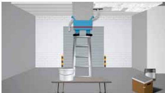
\* يتم لصق لوحة العازل الحراري التي تم دهن المادة اللاصقة على سطها بحيث تكون بعيدة عن الواح العازل الأخرى التي تم لصقها على السقف بمسافة 2 سم. والضغط عليها براحة اليد ودفعها نحو اللوحة التي بجانبها ويتم دعمها براحة اليد لفترة 5 ثواني.
