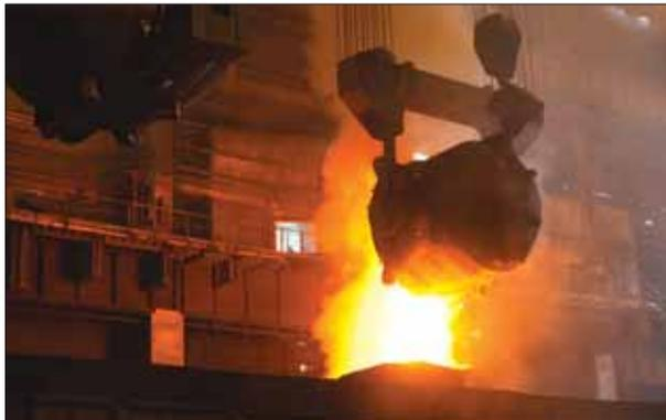
В металлургической структуре известь является особенно эффективной в удалении диоксида кремния, фосфора и серы. Негашенная известь (как с высоким содержанием кальция, так и доломитовая) имеет самое широкое использование в качестве флюса в очищении стали в традиционных сталеплавильных печах с подачей кислорода и в новых электродуговых печах.
