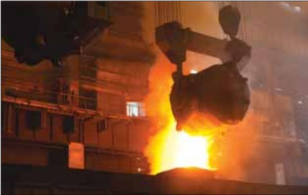
Se utiliza en el sector Hierro-acero para la purificación de los materiales extraños (sílice, fósforo, azufre). En cuanto cal viva (cal de alto contenido de calcio, cal dolomítica) se utiliza en el sector industrial del hierro e del acero y más generalmente en la purificación del acero en el horno a osígeno básico y en el horno eléctrico de arco.
