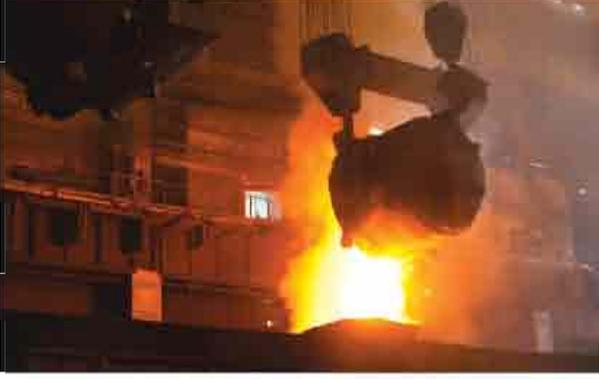
Demir - Çelik sektöründe yabancı maddelerden ( silis, fosfor, sülfür) arıtmak için kullanılır. Sönmemiş kireç olarak ( yüksek kalsiyum, dolomitik ) demir çelik endüstrisindeki en kapsamlı olarak elektrik ark fırınında ve temel oksijen fırınında çeliği safsızlaştırmada kullanılır.
