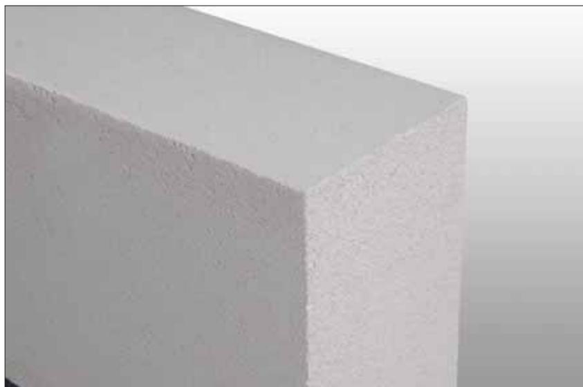
L' AAC generalmente e' prodotto in differenti classi di densita'. Oggi, la maggior parte della produzione dell' AAC nel mondo e' costituito per lo piu' da blocchi aventi la densita' di 400 kg/m<sup>3</sup>.
